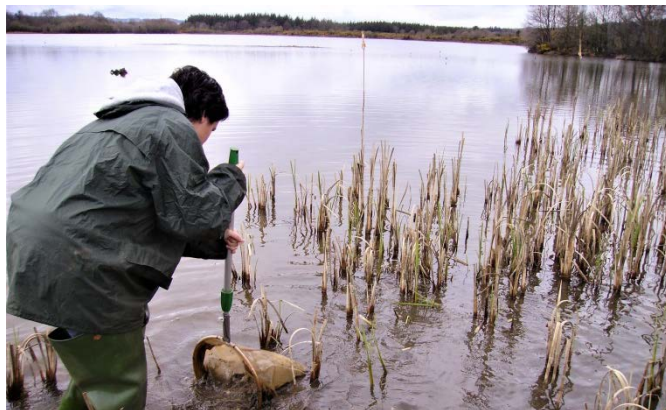
Figura 7. Muestreo realizado en una laguna con la manga entomológica acuática específica
